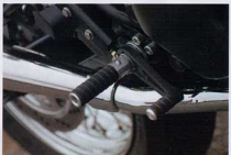
Les commandes reculées comprenant un système de biellettes sur lesquelles sont fixés les repose-pieds font partie d'un kit développé par Mecatwin et qui s'adapte à plusieurs modèles.
