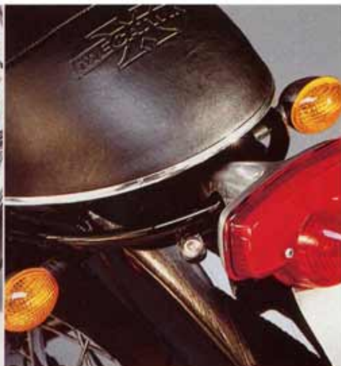
Le petit feu et les mini-clignotants en alu participent grandement à l'allègement de l'arrière de la moto.
