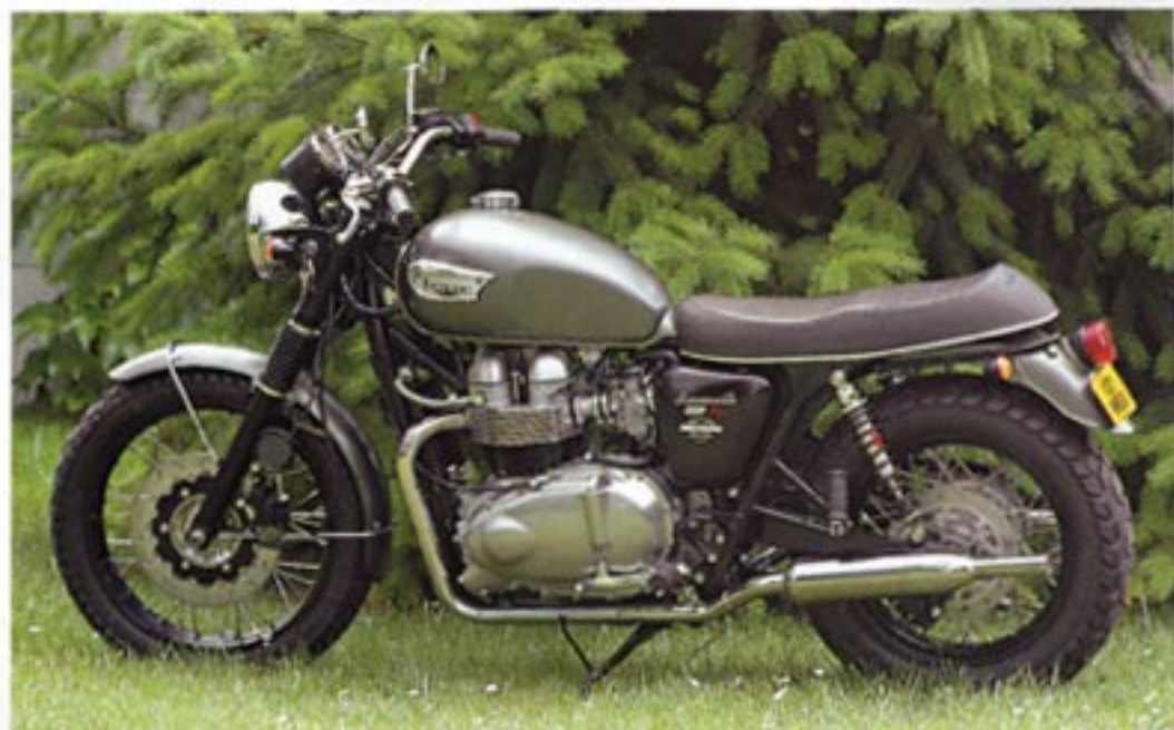
Déclinaison "militaria" pour la TTR en kaki satiné qui adopte les pots saucisson "peashooter" et elle aussi des amortisseurs Bitubo et des jantes noires.
