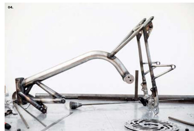
01. Le travail du carrossier commence par le dessin : il y a un client à convaincre. 02. et 03. Puis il se poursuit par le modelage des blocs d'argile. Il s'agit de sculpter en finesse la monocoque. 04. Dans son laboratoire, Franck développe son propre cadre de Bonneville. Il sera bien plus léger que l'élément Triumph!
